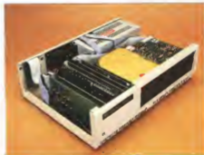
L'unità centrale aperta. Nella la modularità della costruzione: da sinistra a destra troviamo l'alimentatore, il Winchester e il drive per i floppy; sul fondo il alimentatore
